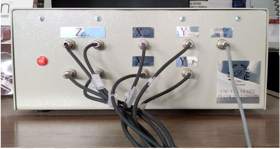
Resim 3.4 Yük ölçen veri toplama PLC cihazı.
