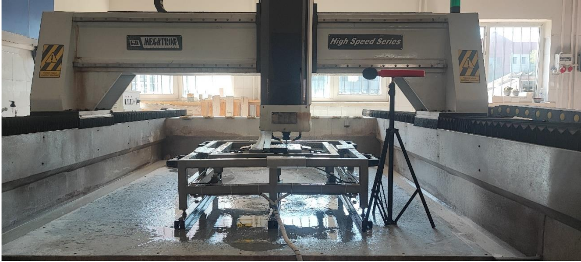
Resim 3.1 Doğal Taş Dikey İşleme Makinesi.
