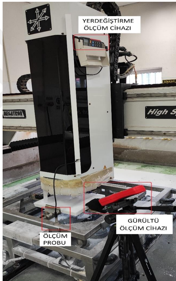
Resim 3.8 Unit UT315A titreşim ve Unit UT 352 gürültü ölçüm cihazları.
