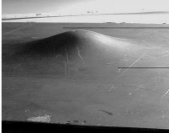
Şekil 2.4 : Sünek malzemede meydana gelen konik şekil [12].
