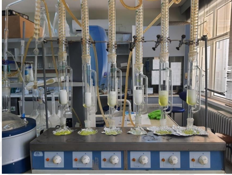
Şekil 3.7. Lipit analizinde kullanılan klasik soxhlet ekstraktörü
