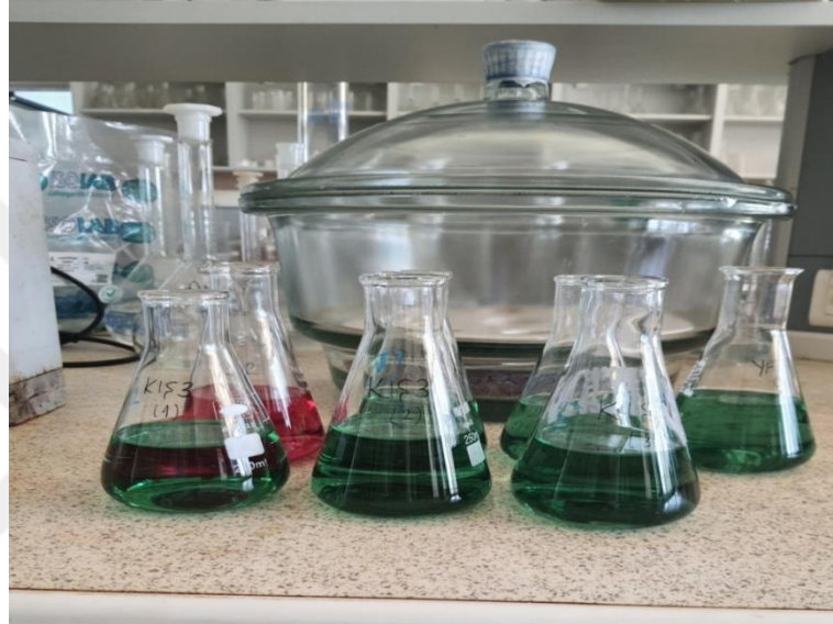
Şekil 3.5. Protein analizinde örneklerin titrasyon için hazırlanması
