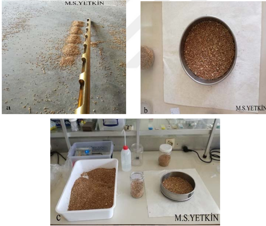
Şekil 3.1. Örnekleme yapılırken kullanılan sonda aleti (a), metal elek (b), saklama kabı ve saklama sıvısı (alkol) (c)
