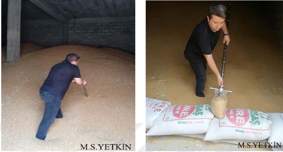
Şekil 3.4. Adi depoda sonda aleti kullanılarak buğday örneğinin alınması
