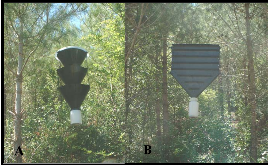
Resim 3. 3. Feromon tuzakları A) Çok hunili tuzak tipi, B) Radyatör (yassı huni) tipi tuzak
