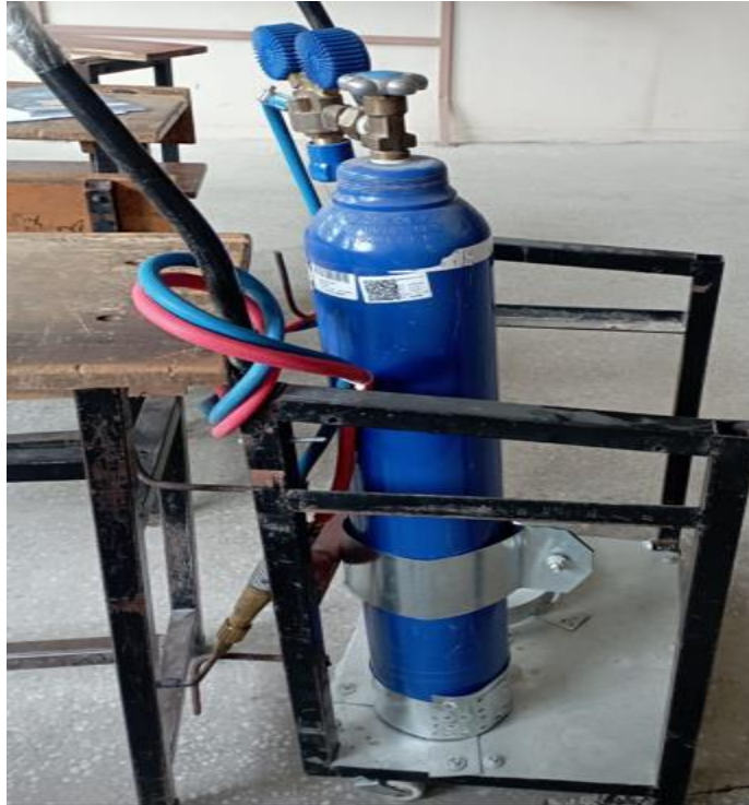
Şekil 4.10. Korunaklı Alanda Bulunmayan Basıncılı Tüp
