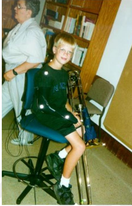
Görsel 5.2. Başlangıç seviyesi trombon icracısının koluna elektronik açı ölçer bağlanmış hali (Kruger ve Lammers, 2000)
