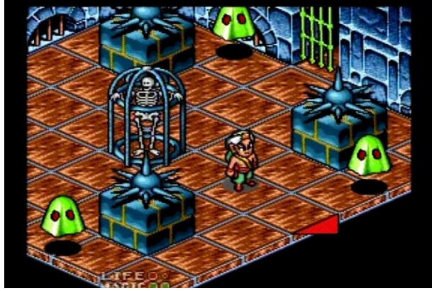
Şekil 1.17. (Sol) Dimetrik bakış, a \neq (b=c) , (http-71 kaynağından faydalanılarak yazar tarafından çizilmiştir.)
