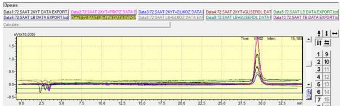
EK Şekil 5. pAC-EHER-EBLidi içeren E. coli EPI300 suşunun farklı besiyerlerindeki 72.saatte ekstrakte edilen likopene ait kromatogram
