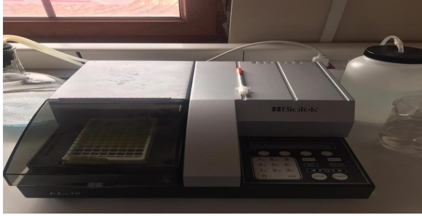
Şekil 2.12. ELISA BioTek EL×50 otomatik yıkayıcı ile yıkama aşaması
