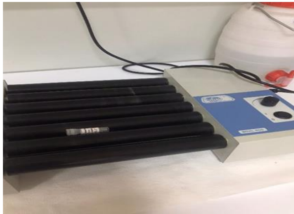
Şekil 2.7. Yatay karıştırıcıda standartların homojen hale getirilmesi
