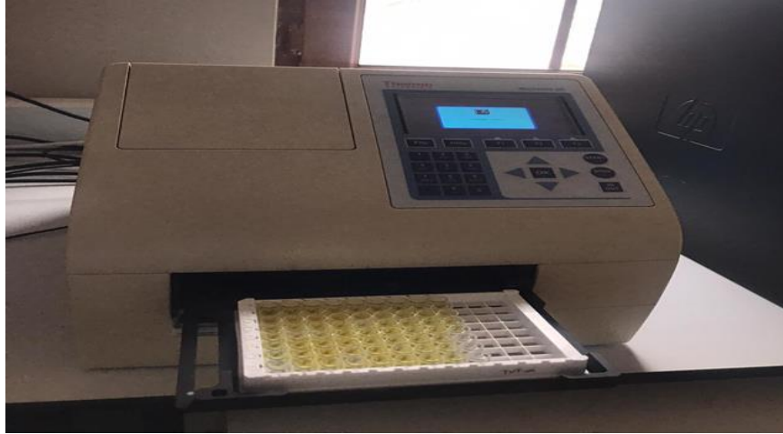
Şekil 2.14. Thermo Scientific, Multiskan GO cihazında mikropolanın okuma aşaması
