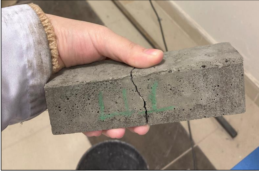
Resim 4.2. U serisinin kopma sonrası görseli
