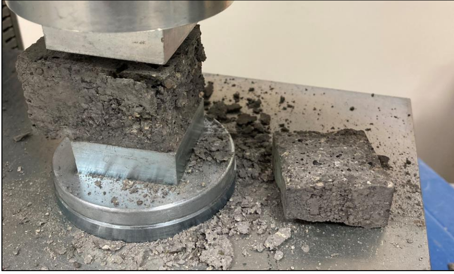
Resim 4.3. YM2 serisinin kırılma görseli
