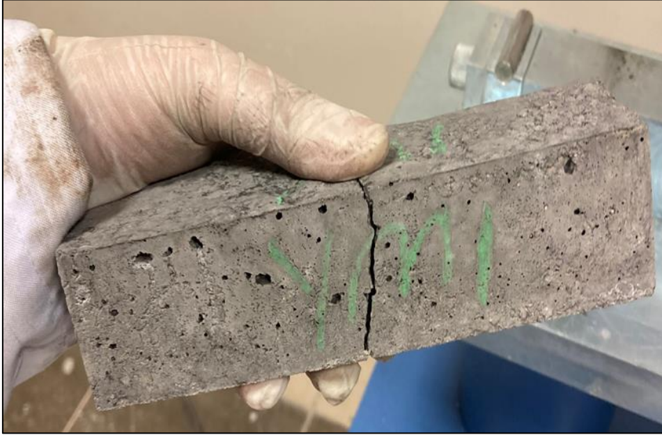
Resim 4.1. YM2 serisinin kopma sonrası görseli
