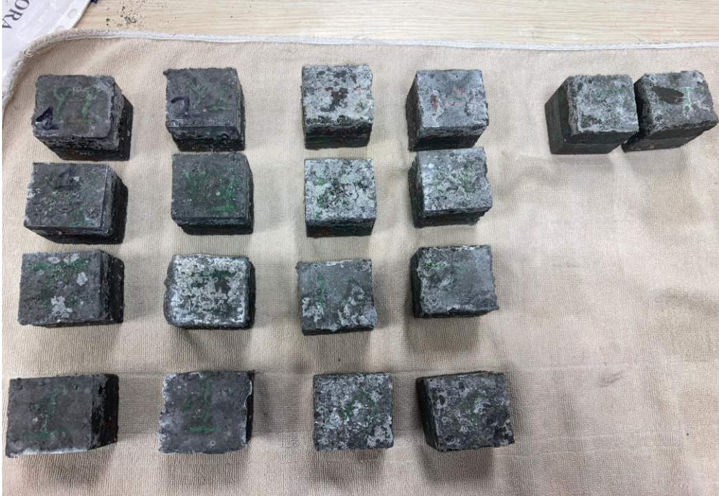
Resim 4.5. Y, YM1, YM2, YU1, YMU1, YMU2, YU2, YMU3 ve U serilerinin kılcal su emme deneyi sonundaki görselleri
