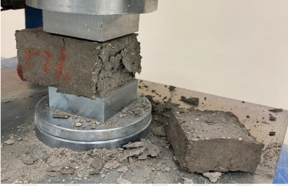
Resim 4.4. YU3 serisinin kırılma görseli
