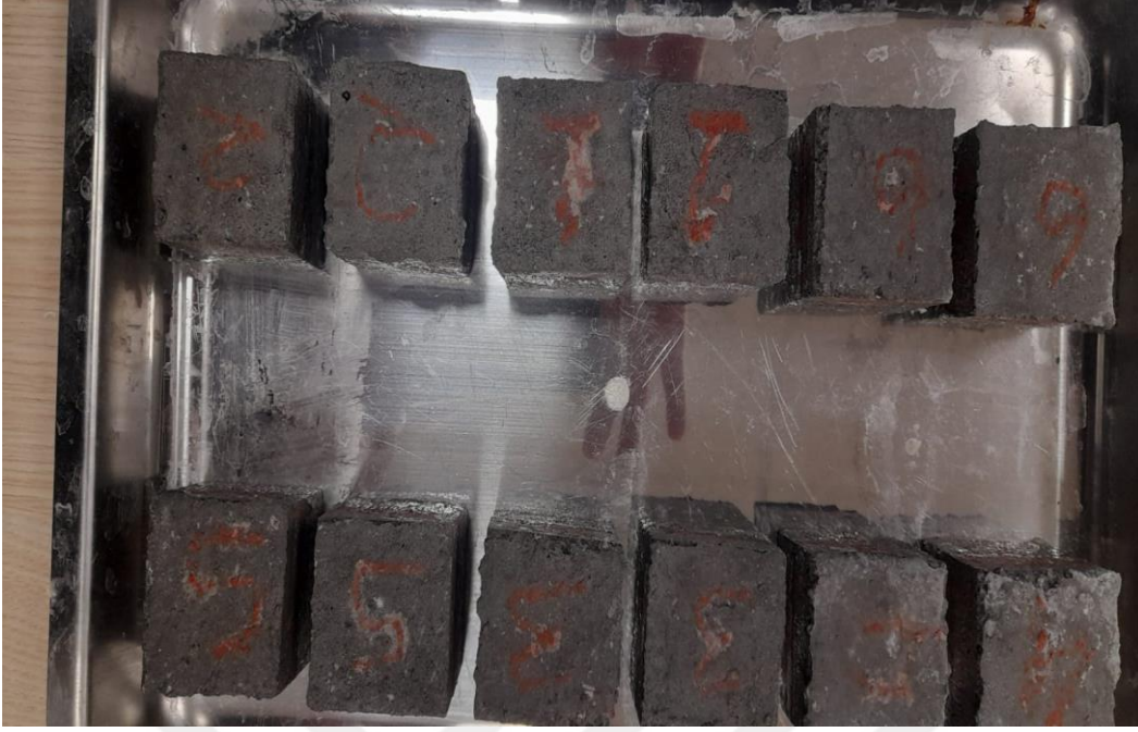
Resim 4.6. YMU4, YU3, YMU5, YMU6, UM1 ve UM2 serilerinin kılcal su emme deneyi sonundaki görselleri
