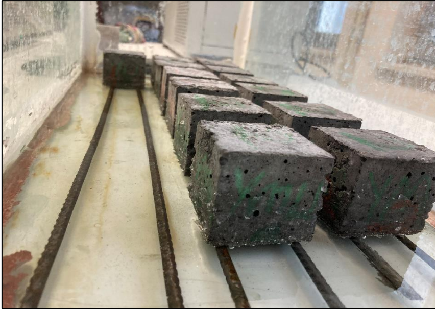
Resim 3.16. Kılcal geçirimlilik deneyi için hazırlanan numunelerin bırakıldığı düzenek
