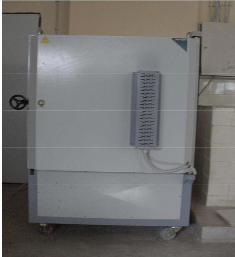
Şekil 7.1. Prothern HLF 150 Laboratuvar Tipi Fırın
