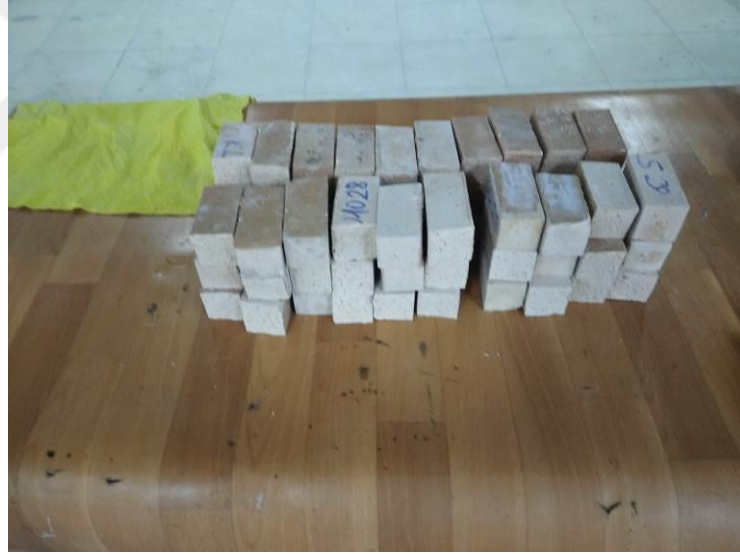
Şekil 4.22. Eğilme deneyine tabi tutulan ve ikiye ayrılan geopolimer harç numuneleri
