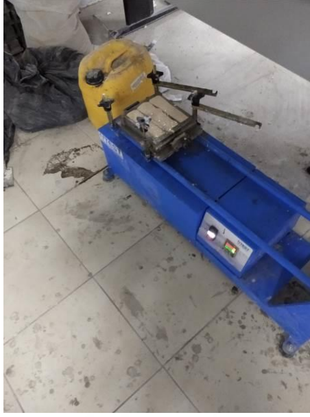
Şekil 4.15. Geopolimer harçların yerleştirilmesinde kullanılan sarsma tablası
