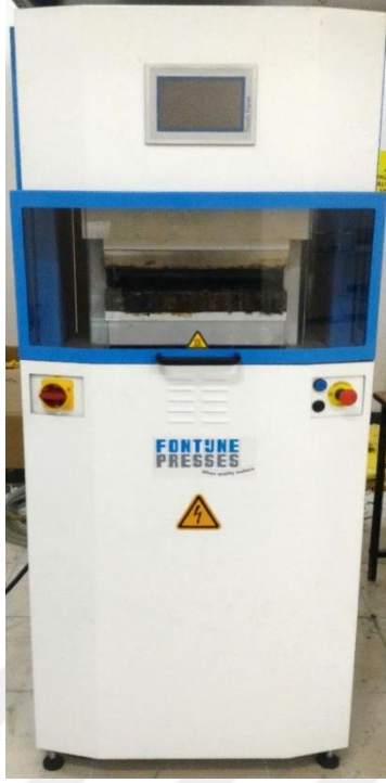
Şekil 2.9 Çalışmada kullanılan Fontijne LabEcon 600 pres cihazı (Kişisel arşiv, 2019)
