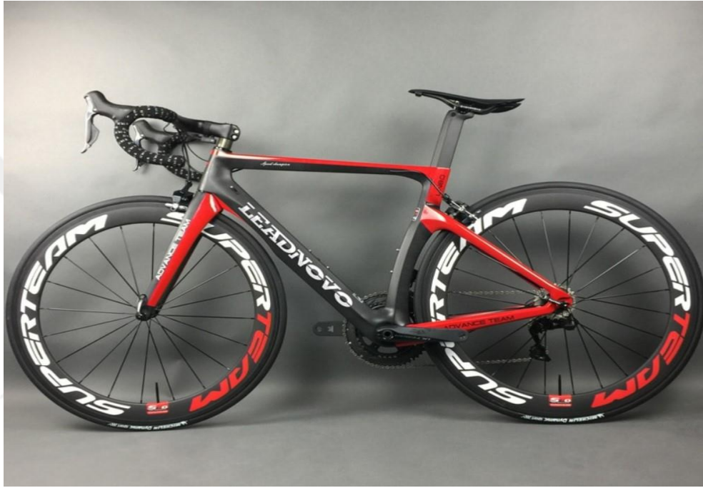
Şekil 2.2 Bir bisiklet gövdesinde kullanılan karbon fiber kompozit örneği (Kişisel arşiv, 2020)
