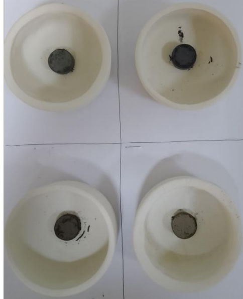
Şekil 3.4 Sinterlenmek üzere hazırlanmış numune örnekleri
