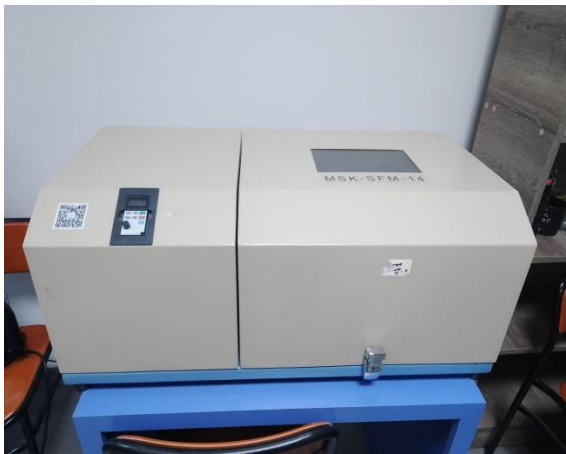
Şekil 3.2 Tozların karıştırıldığı bilyalı yatay değirmen
