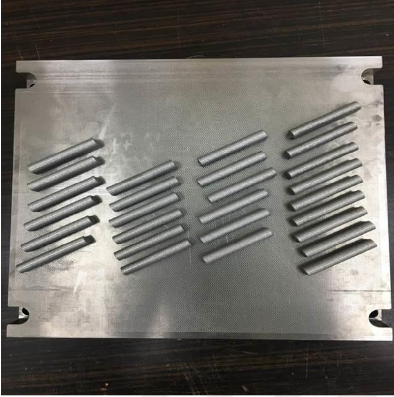
Resim 3.1. Eklemeli imalat tablasındaki eğme testi numuneleri
