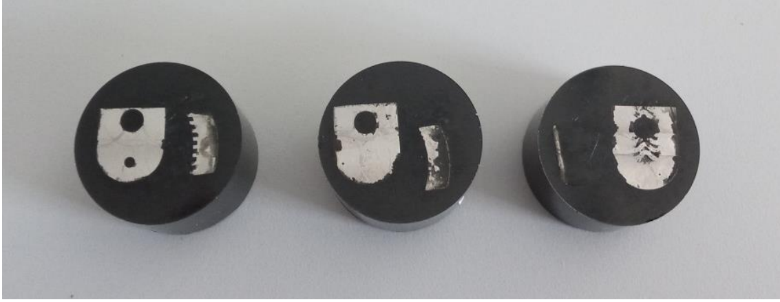
Resim 6.35. Mikro yapı incelemesi öncesinde bakalit içerisindeki numuneler
