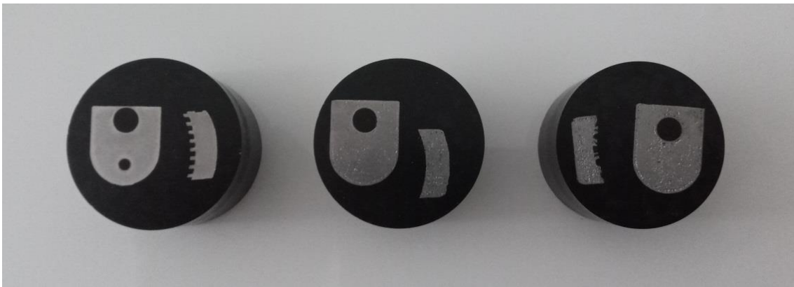
Resim 6.36. Mikro yapı incelemesi yapılan numuneler
