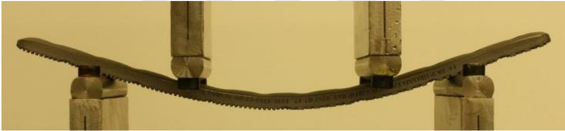
Resim 6.2. Kemik plağı dört nokta eğme testi (test sonrası)
