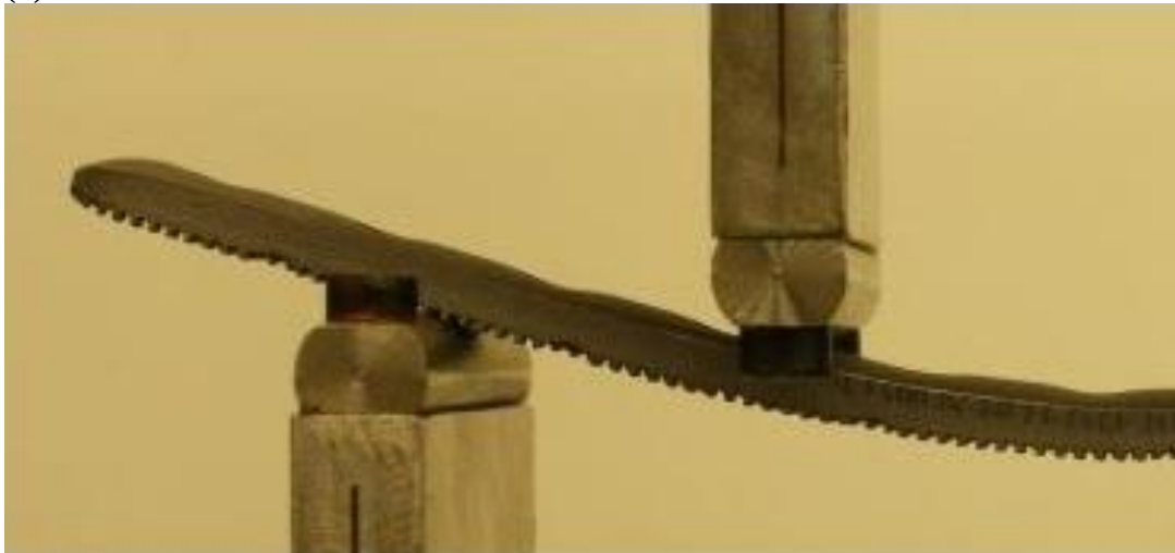
Resim 6.12. Dört nokta eğme analizleri ve testinin yer değiştirme sonuçları: (a) MSC Nastran sonucu (mm), (b) MSC Marc sonucu (mm), (c) test sonucu
