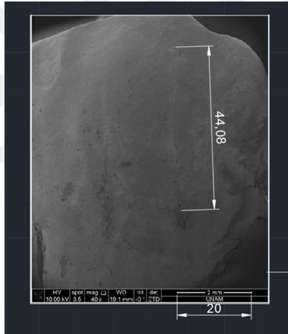
Şekil 3.16. SEM görüntüleri üzerinde incelenen en uzun çatlakın boyunun ölçümü
