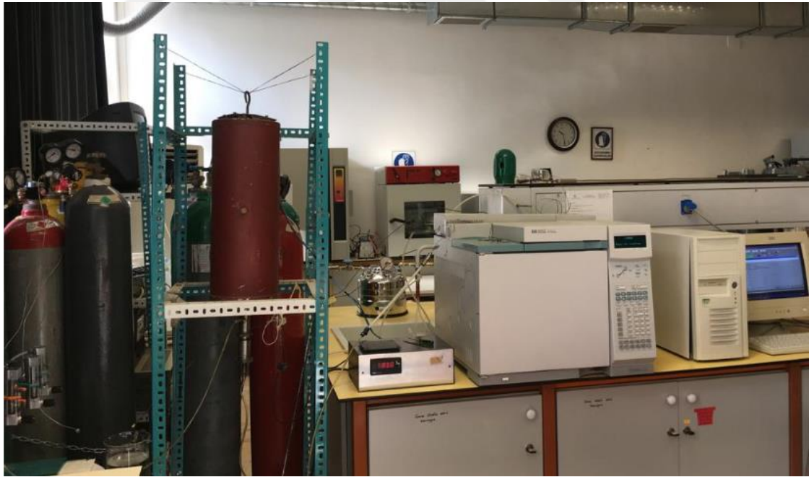
Şekil 3.7. Metanın kuru reformlanma reaksiyonu deney sistemi görünümü (Eskişehir Teknik Üniversitesi Kimya Mühendisliği Bölümü Yakıt Hücreleri ve Hidrojen Teknolojileri Araştırma Laboratuvarı).
