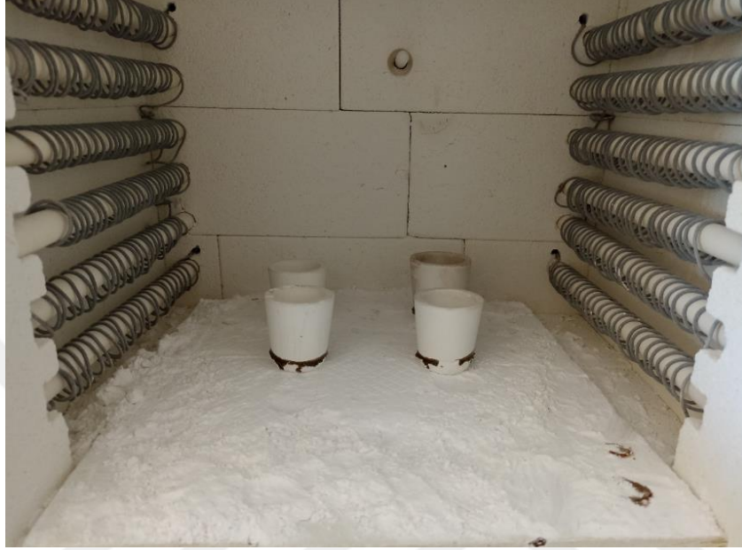
Şekil 3.1 Hidroksiapatit ve metal iyon katkılı Hidroksiapatitin sinterlenmesi.
