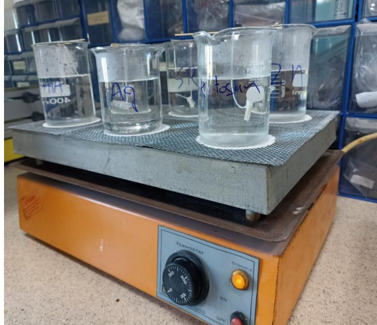
Resim 3.11 Su emme test düzeneği.
