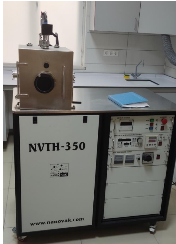
Şekil 3.9. Al metal kaplamasında kullanılan PVD cihazının fotoğrafı.
