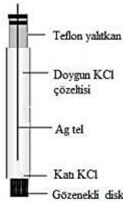
Şekil 2.6: Ag/AgCl referans elektrodu.
