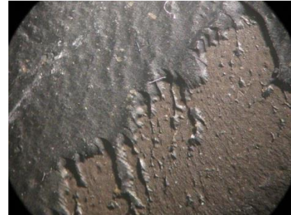
Şekil 5. 2 Kopma testi sonrası plakanın mikroskop altındaki görüntüsü
