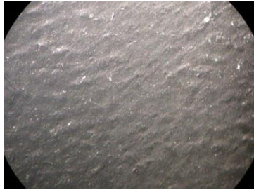
Şekil 5. 10 Kopma testi sonrası plakanın mikroskop altındaki görüntüsü
