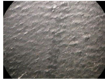
Şekil 5. 10 Kopma testi sonrası plakanın mikroskop altındaki görüntüsü
