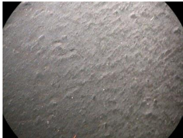
Şekil 5. 8 Kopma testi sonrası plakanın mikroskop altındaki görüntüsü
