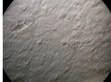
Şekil 5. 8 Kopma testi sonrası plakanın mikroskop altındaki görüntüsü
