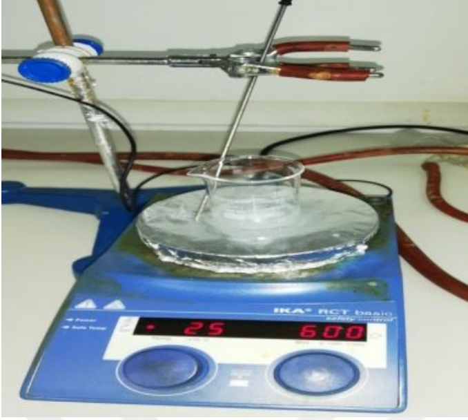
Şekil 9. Sodyum süksinat tuzunun çökmesi için karıştırıcıda karıştırılması yapıldı.
