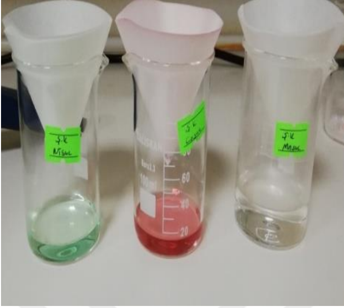
Şekil 14. Numunelerin süzme işlemi gerçekleştirildi ve kristalleşmeye bırakıldı.
