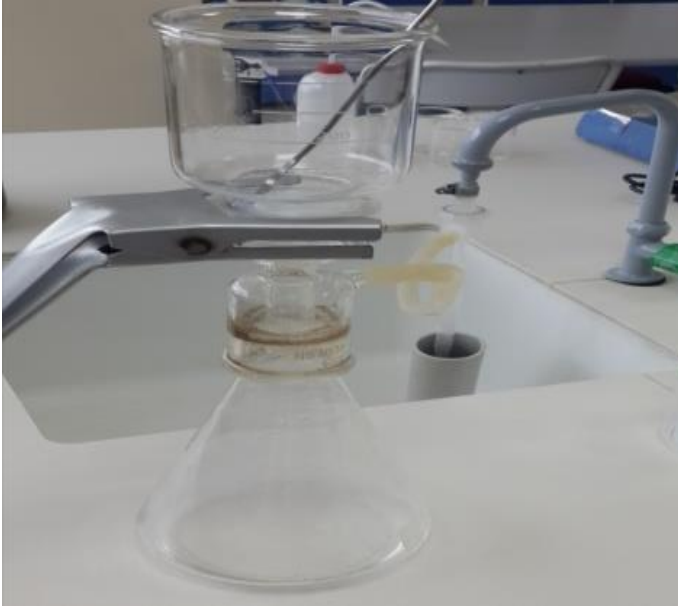
Şekil 12. Kobalt sülfat, bakır sülfat, nikel sülfat, mangan sülfat numunelerinin süzme işlemleri gerçekleştirildi.
