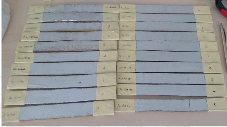
Resim 3.8 Çekme testi için hazırlanan numuneler
