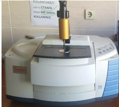
Şekil 3.13. Thermo Scientific Nicoletti S10 model FTIR cihazı.
