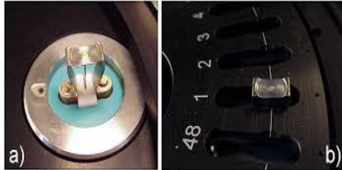
Şekil 3.4. (a) Risø TL/OSL DA-20 model cihazdan bulunun ısıtıcı aparatı (b) Örnek tablası üzerinde TL okuma süresinde kaldırma sisteminden bir kesit (Universitet, 2008).
