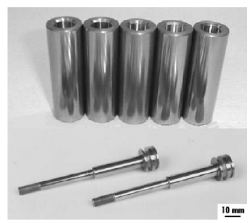
Şekil 4.7. Yüksek modül çelik kompozitten üretilmiş deneme otomobil motoru parçaları
