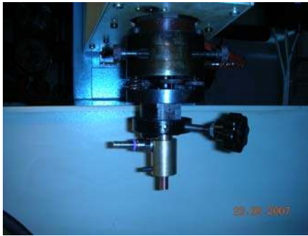
Resim 4.3. Dielektrik sıvı uygulama adaptörü görünüşü
