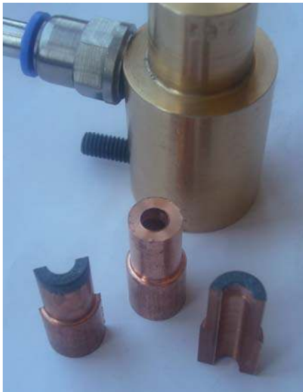
Resim 4.5. FOCUS Model CNC torna tezgâhında işlenerek hazırlanan elektrot takımı
