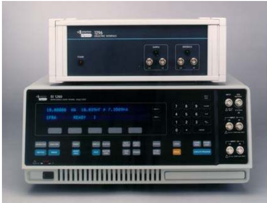
Resim 4.8. Solartron 1260 ve 1296 marka yüksek frekans empedans analiz cihazı
