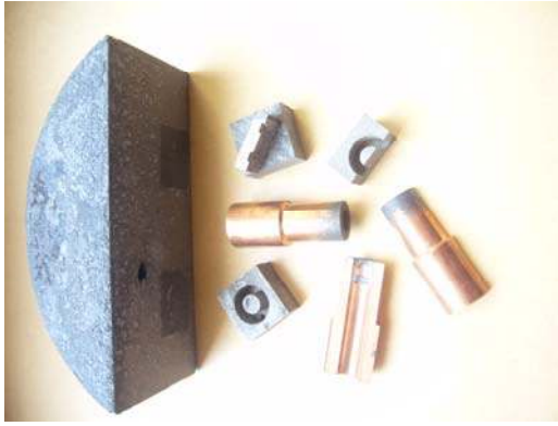
Resim 4.6. Tel EEİ tezgâhında kesilmiş malzeme çifti ( elektrot-iş parçası ) örnekleri
