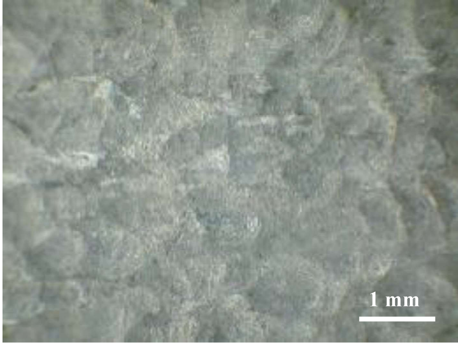
Şekil 6.9 %15 oranında SiC takviyesi içeren numunenin ultrasonik dövme işlemi sonrasında meydana gelen yüzeyi
