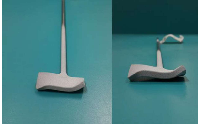
Şekil 5.2 Deneylerde kullanılan karıştırıcı çubuk (Kişisel arşiv, 2018)
