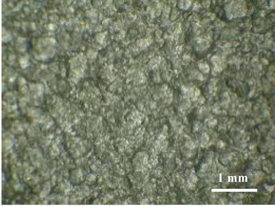
Şekil 6.4 %5 oranında SiC takviyesi içeren numunenin bilyalı dövme işlemi sonrasında meydana gelen yüzeyi
