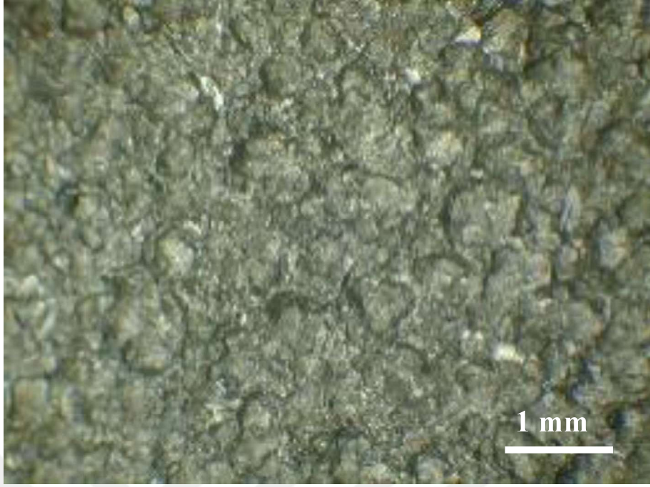
Şekil 6.8 %15 oranında SiC takviyesi içeren numunenin bilyalı dövme işlemi sonrasında meydana gelen yüzeyi
