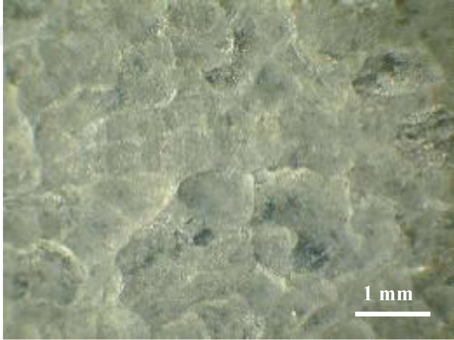
Şekil 6.7 %10 oranında SiC takviyesi içeren numunenin ultrasonik dövme işlemi sonrasında meydana gelen yüzeyi
