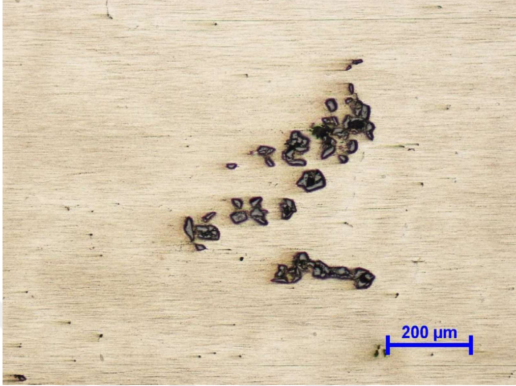
Şekil 6.16 %10 oranında SiC takviyesi içeren numunenin mikro yapı görüntüsü
