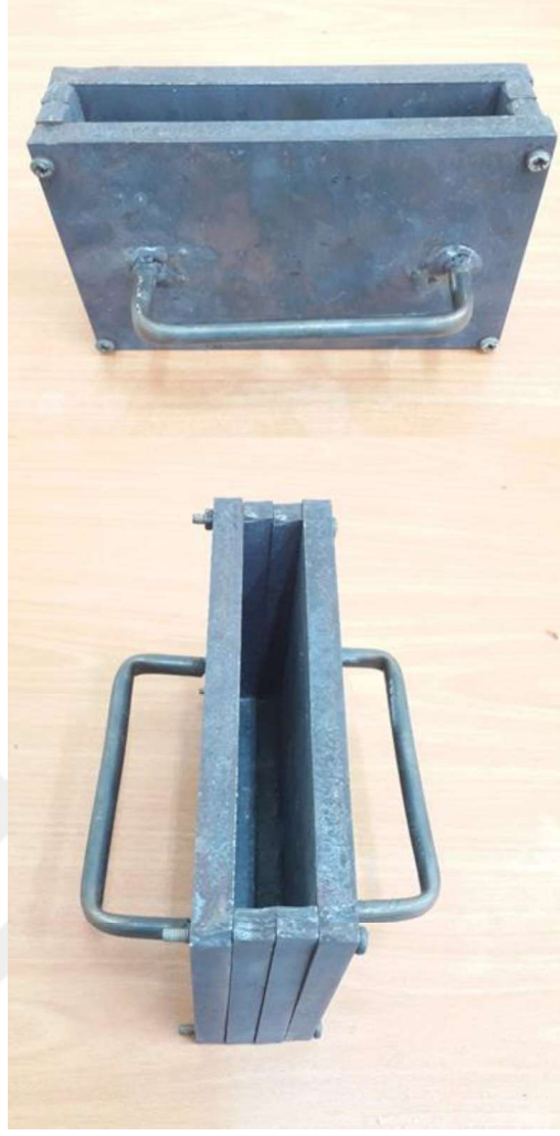
Şekil 5.3 Deneylerde kullanılan döküm kalıbı (Kişisel arşiv, 2018)
