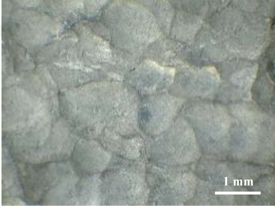
Şekil 6.5 %5 oranında SiC içeren numunenin ultrasonik dövme işlemi sonrasında meydana gelen yüzeyi
