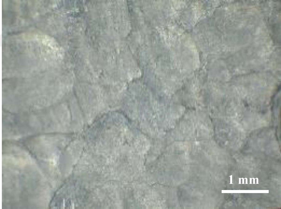
Şekil 6.3 SiC takviyesi içermeyen numunenin ultrasonik dövme işlemi sonucu meydana gelen yüzeyi
