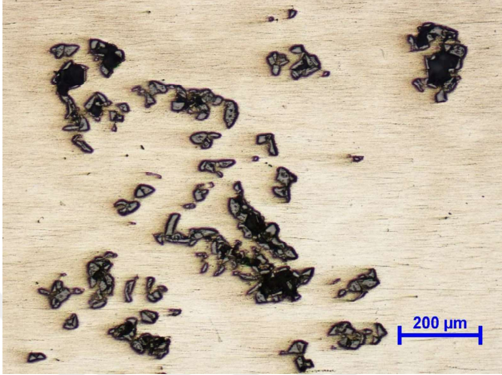
Şekil 6.20 %20 oranında SiC takviyesi içeren numunenin mikro yapı görüntüsü
