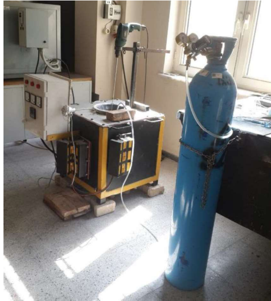
Şekil 5.1 Döküm işlemlerinde kullanılan sistem (Kişisel arşiv, 2018)
