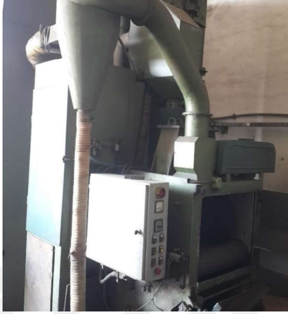
Şekil 5.4 Bilyalı dövme işleminde kullanılan santrifüj bilyalı dövme makinası (Kişisel arşiv, 2018)
