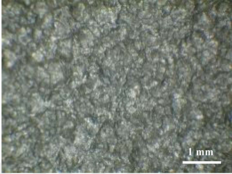
Şekil 6.6 %10 oranında SiC takviyesi içeren numunenin bilyalı dövme işlemi sonrasında meydana gelen yüzeyi
