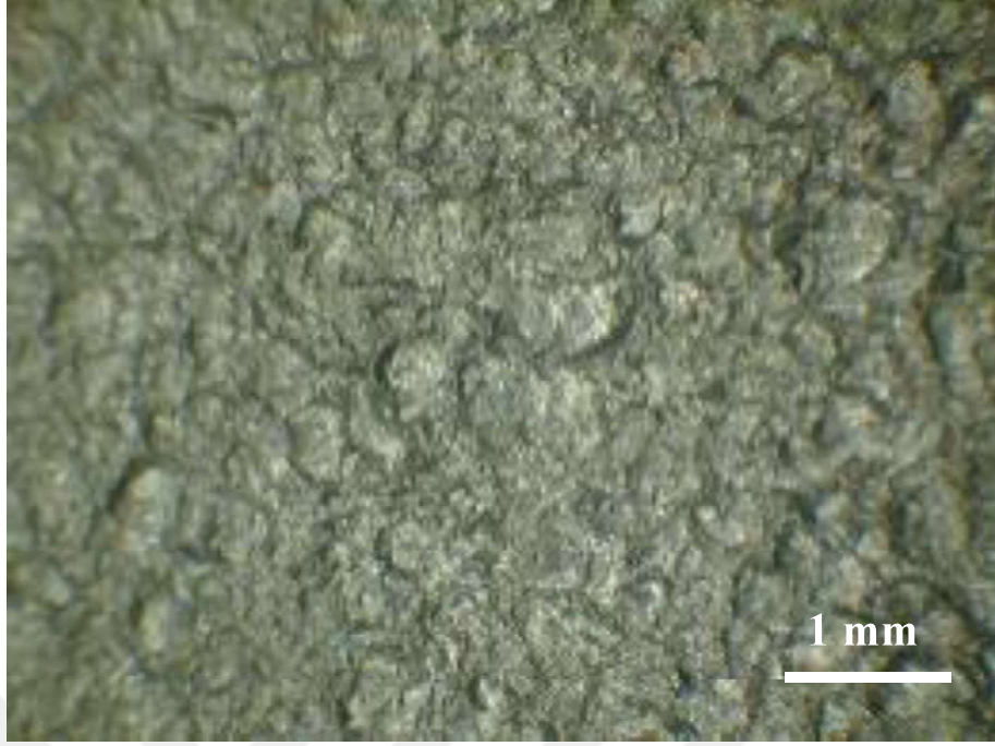
Şekil 6.2 SiC takviyesi içermeyen numunenin bilyalı dövme işlemi sonrasında meydana gelen yüzeyi
