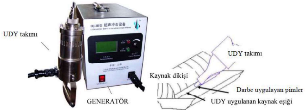
Şekil 4.4 Ultrasonik dövme yöntemi sistemi (Kahraman, Yolcu ve Kahraman, 2016)
