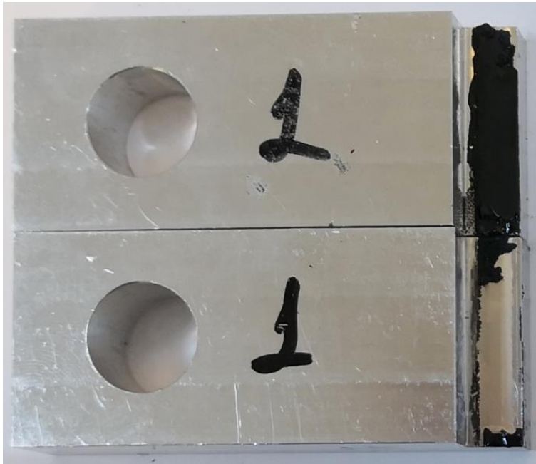
Resim 6.1. Adeziv kopma göstermiş TAST tipi numune
