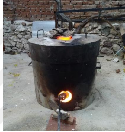
Görsel 3.21. Deneme plakalarının fırına yerleştirilmesi ve redüksiyon pişirimi (Yörük,2020)
