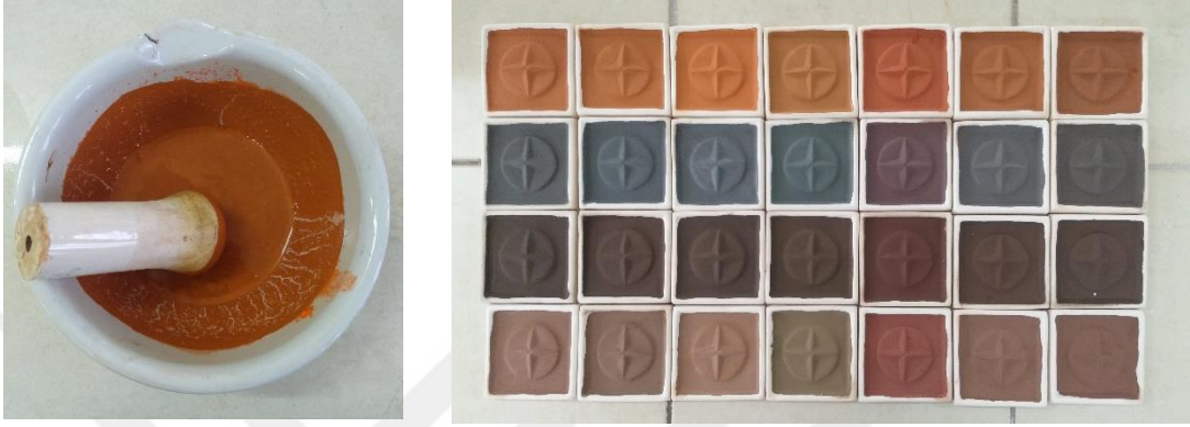
Görsel 3.18. Deneme plakalarının sırlanma aşamaları (Yörük,2020)
