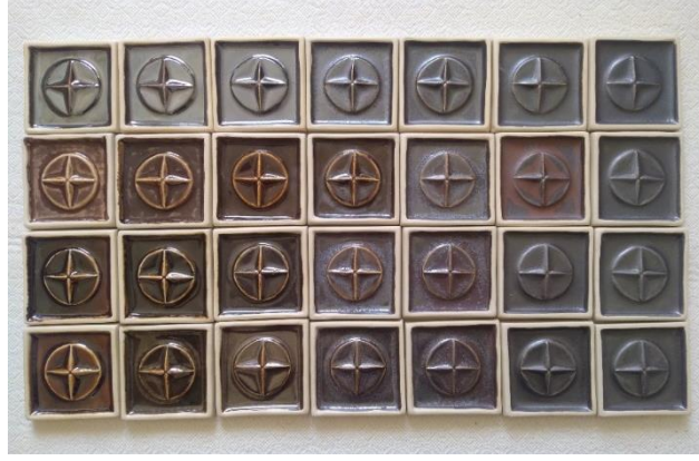
Görsel 3.20. Nötr fırın atmosferinde pişirilen metalik sır örnekleri (Yörük,2020)
