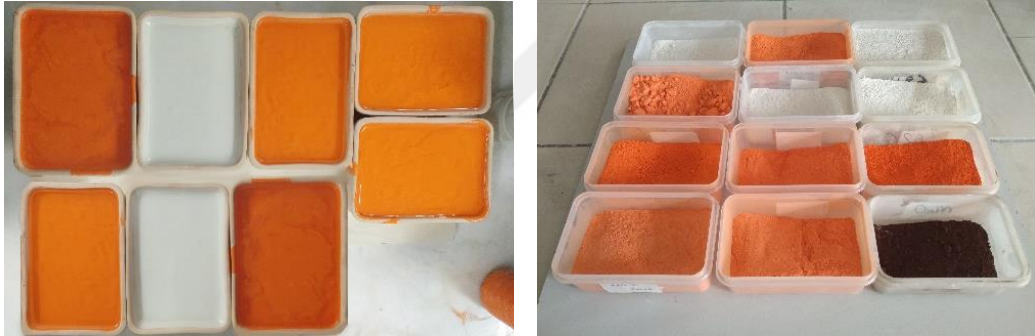
Görsel 3.17. Öğütülen sırların kurutulma aşamaları (Yörük,2020)
