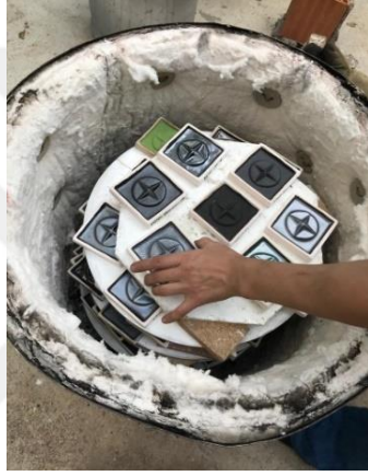
Görsel 3.21. Deneme plakalarının fırına yerleştirilmesi ve redüksiyon pişirimi (Yörük,2020)
