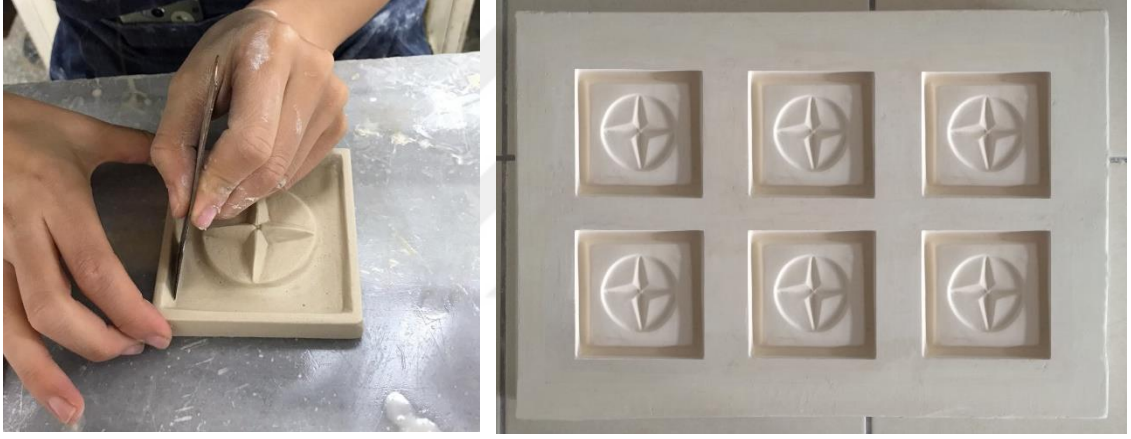
Görsel 3.14. Deneme plakasının modellenmesi ve alçı kalıp ile çoğaltma aşamaları (Yörük,2020)
