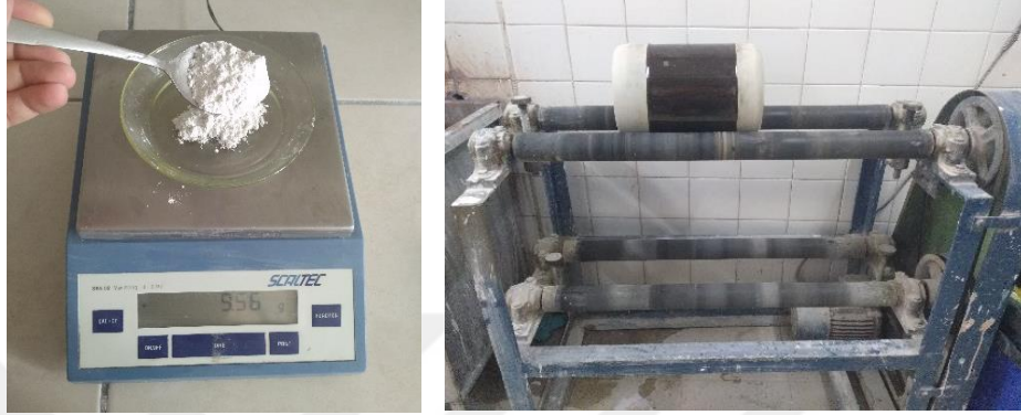
Görsel 3.16. Sırların tartım ve öğütme aşamaları (Yörük,2020)
