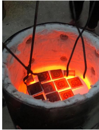
Görsel 3.22. Piştirimi yapılan plakaların fırından çıkartılması (Yörük,2020)
