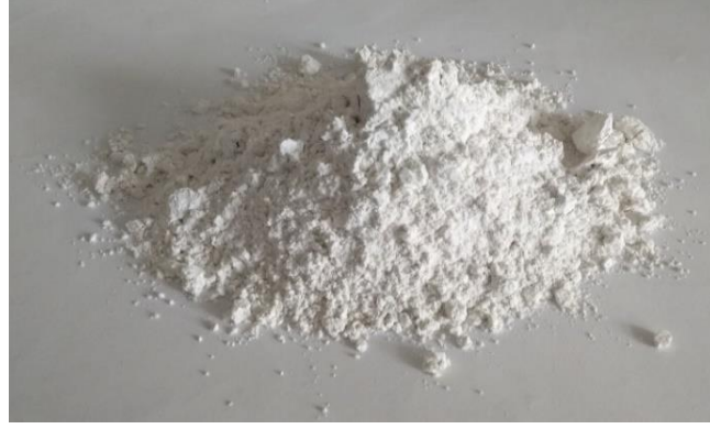
Görsel 3.10. Sodyum Feldspat (Yörük,2020)
