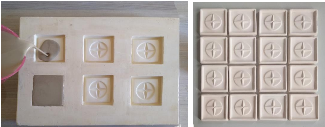
Görsel 3.15. Deneme plakalarının alçı kalıptan döküm çamuru ile çoğaltılması (Yörük,2020)
