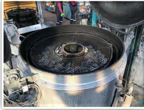
Şekil 4.3. Parçanın kaplanması ve sonrasındaki santrifüj işlemi
