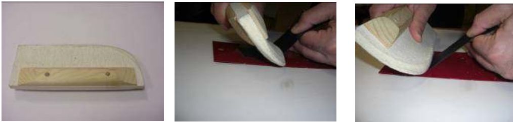
Şekil 4.10. Kaplama sonrası yapışma bandı uygulama yöntemi
