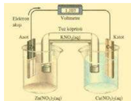
Şekil 2.1. Elektrokimyasal hücrenin şematik gösterimi
