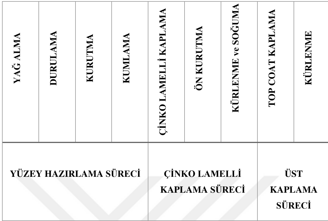
Şekil 4.2. Çinko lamelli kaplama iş akış diyagramı
