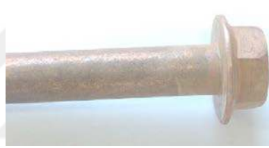
Şekil 4.7. Hogaboom testinden başarısız olan parça
