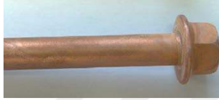
Şekil 4.6. Hogaboom testinden başarılı olan parça
