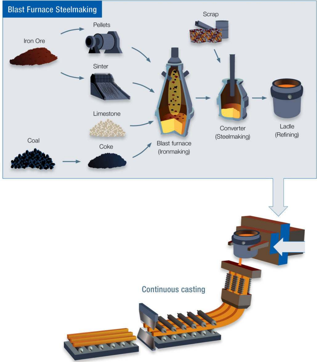
Şekil 4 Yüksek fırında çelik üretimi (17).
