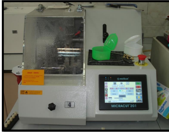
Resim 3.2. Metkon™ Micracut 201 kesme cihazı
