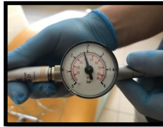
Resim 3.3. Kojet ile kumlama işlemi öncesi basıncın ayarlanması
