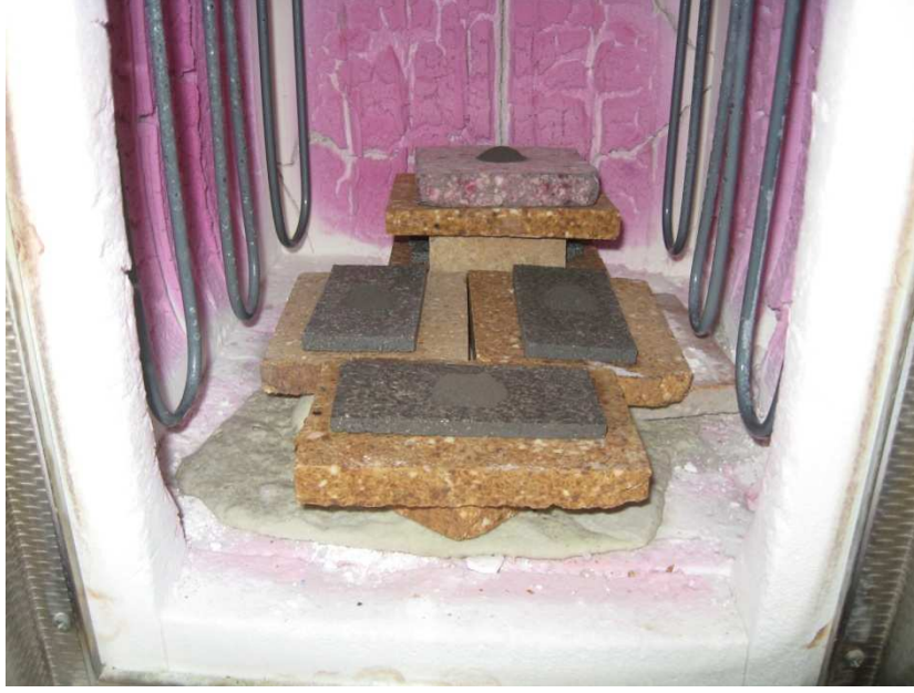
Resim 3.5 Dikdörtgen korozyon test numuneleri
