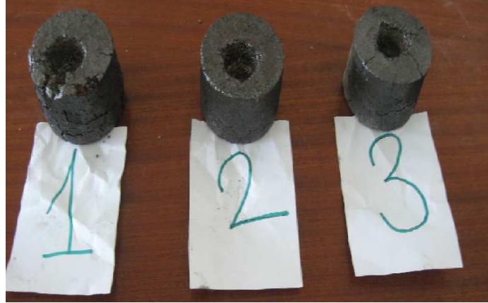
Resim 3.4 Korozyon testi için delik açılan silindirik numuneler
