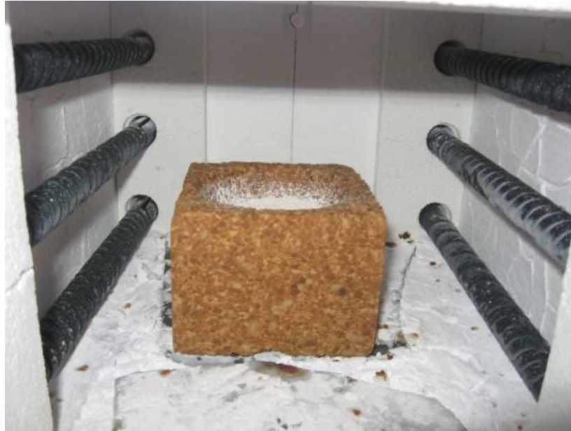
Resim3.1 Kroze içindeki hammaddenin sinterleme öncesinde ki görüntüsü
