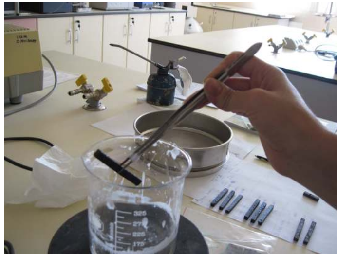
Resim 3.3 Numunelerin parafin ile kaplanması
