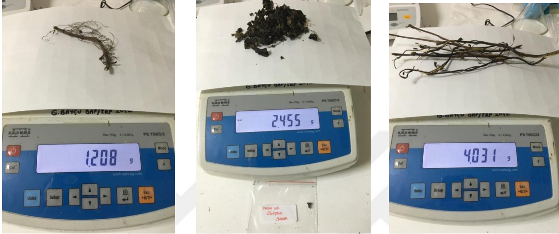
Şekil 3.6: Radwag hassas terazide kuru ağırlıkların tartımı
