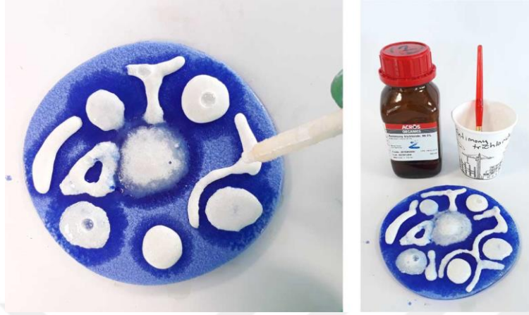
Şekil 7.53. Hazırlanan Karışımın Uygulanması ve Fırınlamaya Hazır Plaka
