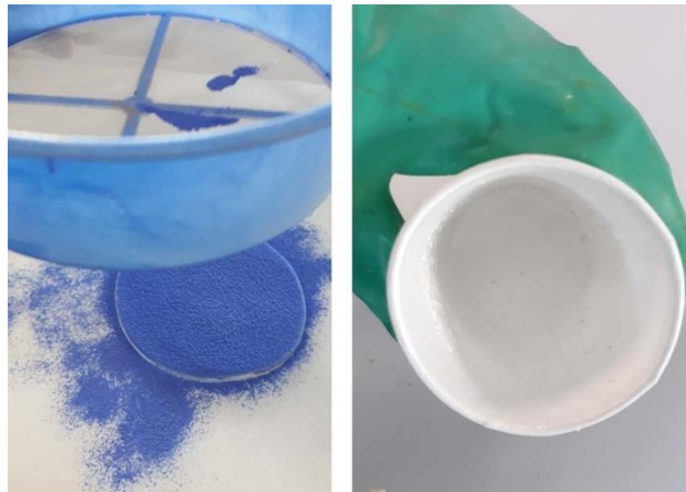
Şekil 7.52. Plakanın Toz ile Kaplanması ve Hazırlanmış Karışım
