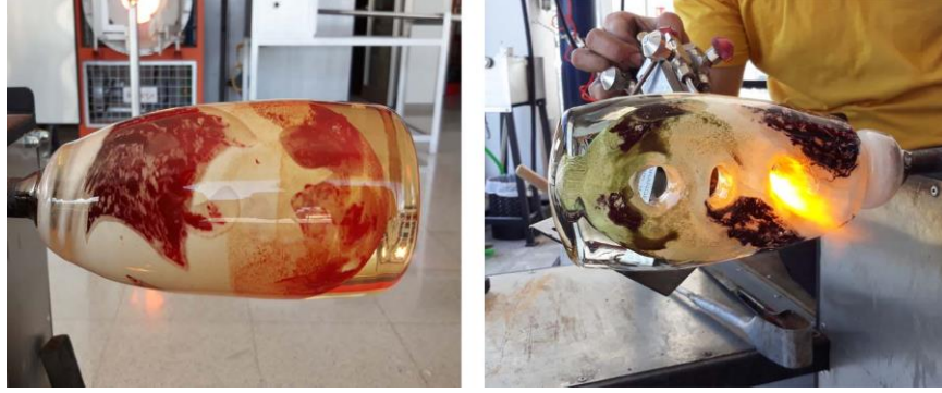
Şekil 8.6. Son Katman Sarılmış Cam ve Bölgesel Isıtmanın Yapılması
