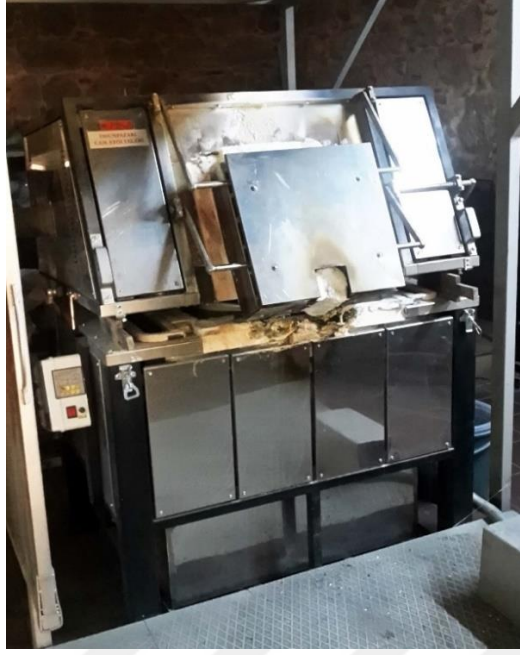
Şekil 7.1. Elektrik Enerjisi ile Çalışan Potalı Fırın Fotoğraf: Emir Özkaya Tarafından Çekilmiştir
