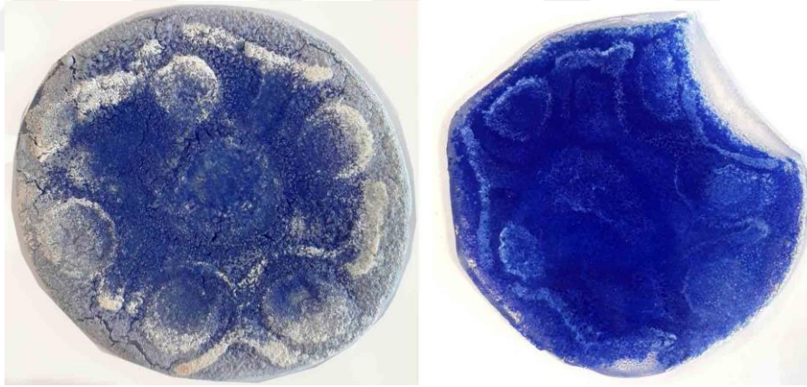
Şekil 7.54. Antimon Triklorür İle Üretilen Ürünlere Ait Görsel (a) 900°C (b) 1000°C'de Yapılan Çalışmalar
