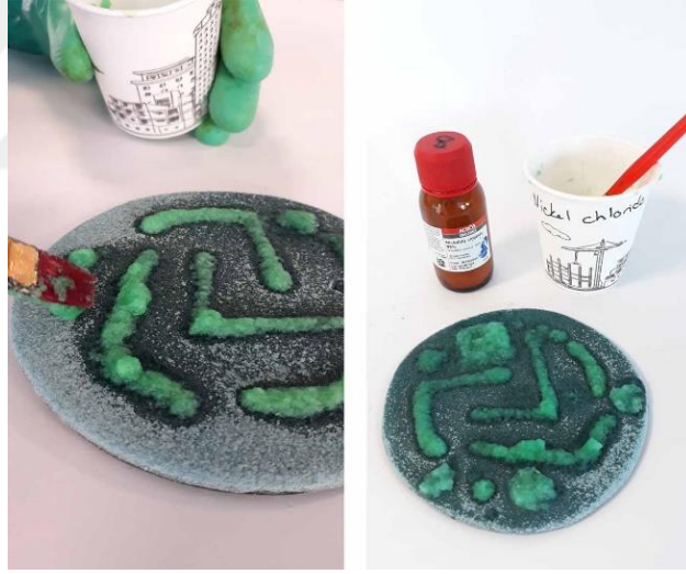
Şekil 7.39. Hazırlanan Karışımın Uygulanması ve Fırınlamaya Hazır Plaka
