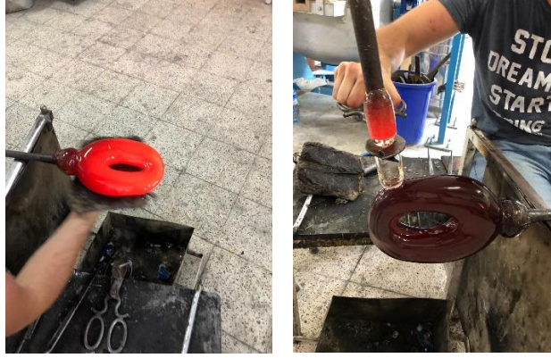
Şekil 8.10. Şekillendirme ve Parça Ekleme
