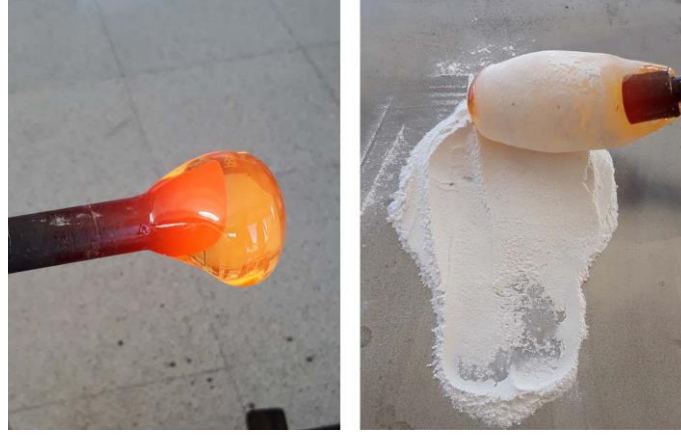
Şekil 8.4. İlk Katman Camın Sarılması ve İkinci Katmanın Üzerine Toz Renk Alınması
