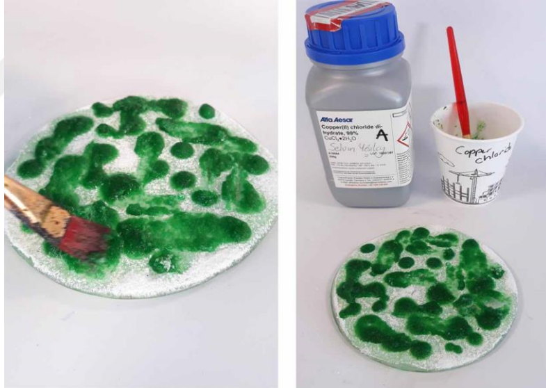
Şekil 7.67. Plakaya Karışımın Uygulanması ve Hazırlanmış Plaka
