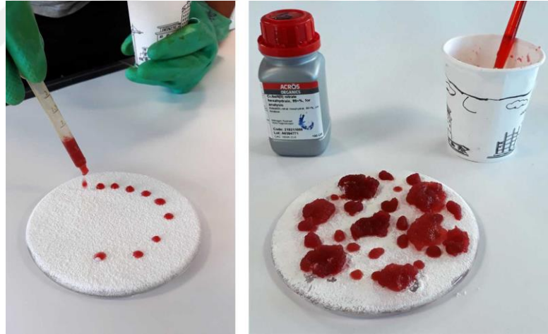
Şekil 7.11. Hazırlanan Karışımın Uygulanması ve Fırınlamaya Hazır Hali
