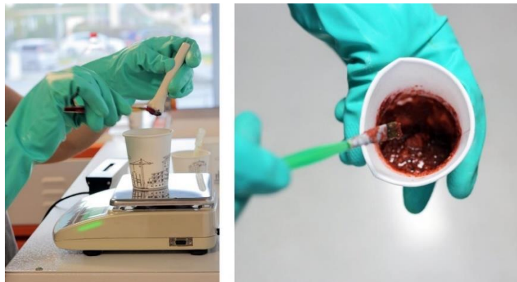
Şekil 7.6. Kobalt Nitrat Hekzahidrat - Kıvamlaştırıcı Karışımının Hazırlanışı
