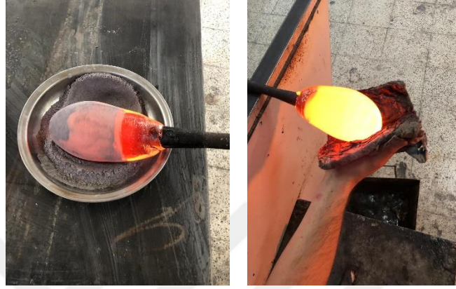
Şekil 8.8. Toz Renk Kaplama ve Şekillendirme İşlemi
