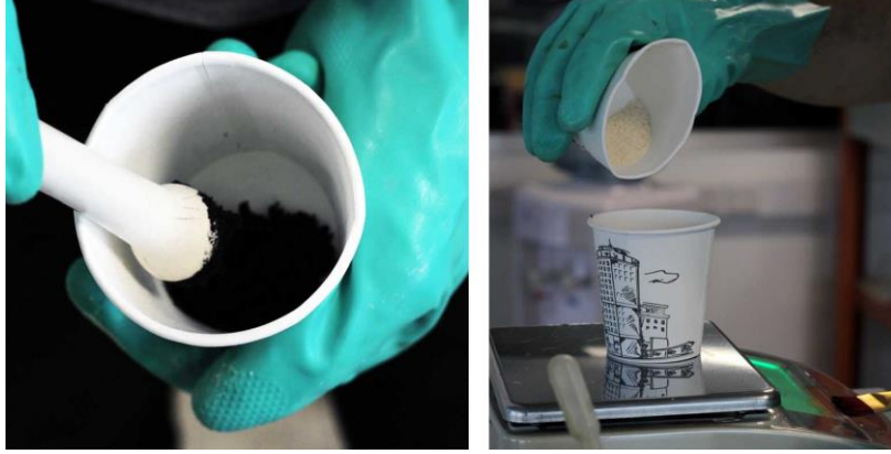
Şekil 7.20. Tuzların Ezilerek İnceltilmesi ve Kıvam Arttırıcının Eklenmesi
