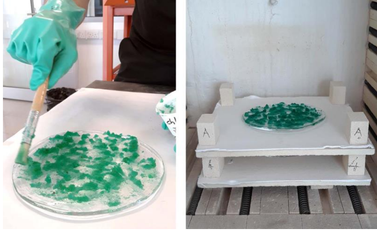
Şekil 7.63. Uygulanmış Karışım ve Fırınlanması
