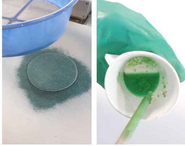
Şekil 7.38. Plakanın Toz ile Kaplanması ve Hazırlanmış Karışım
