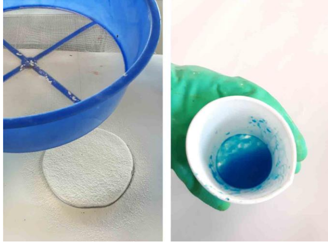
Şekil 7.31. Plakanın Cam Tozları ile Kaplanması ve Hazırlanmış Karışım
