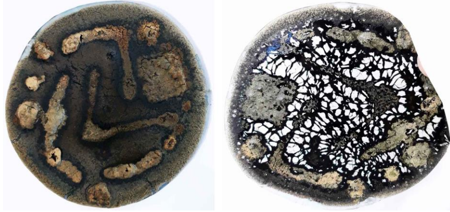
Şekil 7.40. Nikel (II) Klorür ile Üretilen Ürünlere Ait Görsel (a) 900° C (b) 1000° C'de Yapılan Çalışmalar
