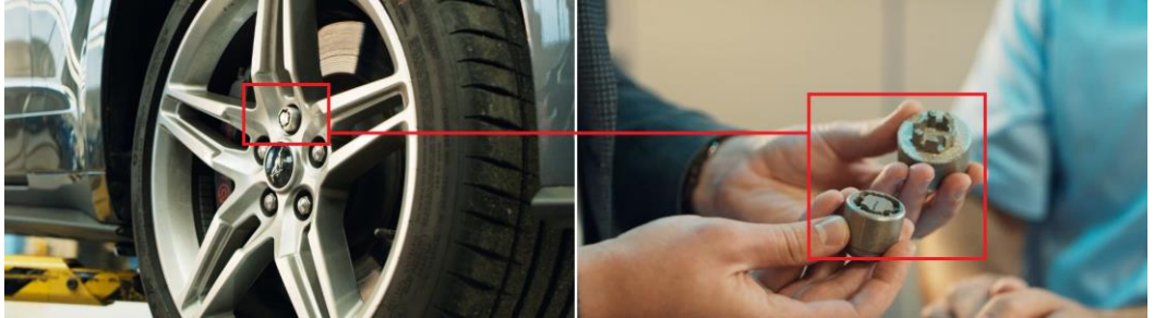
Şekil 2.4 Ses desenine özel üretilmiş bijon ve bijon anahtarı (Ford Media Center, 2022)
