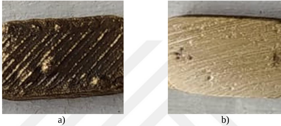
Şekil 4.18 900 °C’de sinterlenen numunenin yüzey ve kesit görüntüsü
