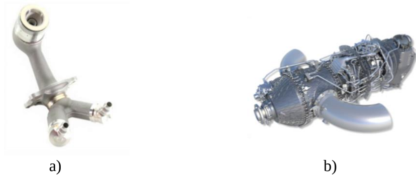
Şekil 2.6 Eİ ile üretilmiş a) yakıt nozulü, b) Turboprop motoru, c) jet kanat braketi ve d) motor kapak menteşesi (Vafadar vd., 2021)
