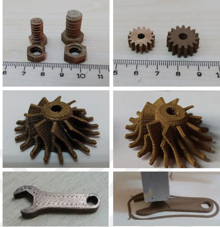
Şekil 4.25 Yazdırılmış ve sinterlenmiş çeşitli karmaşık şekilli parçalar
