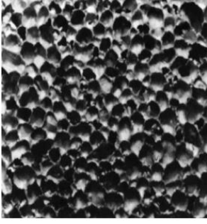
a. Kapalı gözenekli malzeme yapısı
