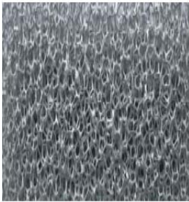
a) Açık gözenekli malzeme yapısı
