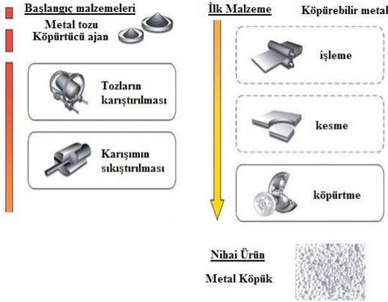
Şekil 2.14 IFAM proses diyagramı
