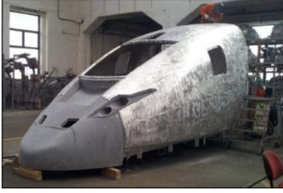
Şekil 3.17 Köpük metalin demiryollarında kullanımı.
