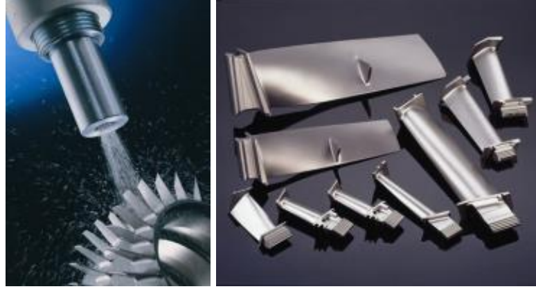
Şekil 2.3 : Bir hava taşıtının parçalarına uygulanan bilyalı dövme işlemi.
