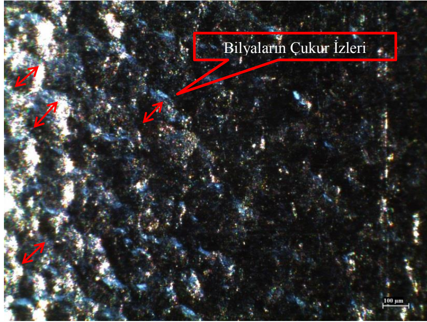
Şekil 5.45 : Ti6Al4V alaşımının A 0.010 Almen dövme şiddetinde dövme sonucunda yüzeyde oluşan çukur ve tümsekler (80X).
