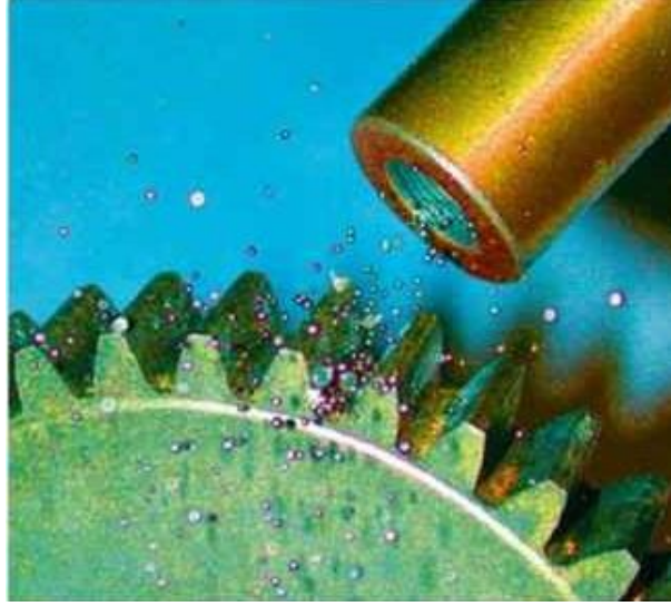
Şekil 2.2 : Bir dişlinin dişlerinin bilyalı dövme işlemi uygulaması.
