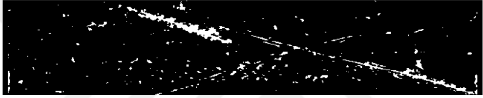
Şekil 5.20. Eşik değeri uygulanmasıyla elde edilen gürültü içeren kusur bölgeleri ikili(binary) görüntüsü.
