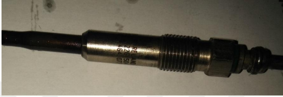
Şekil 2.3. Dizel motorun orijinal kızdırma bujisi.
