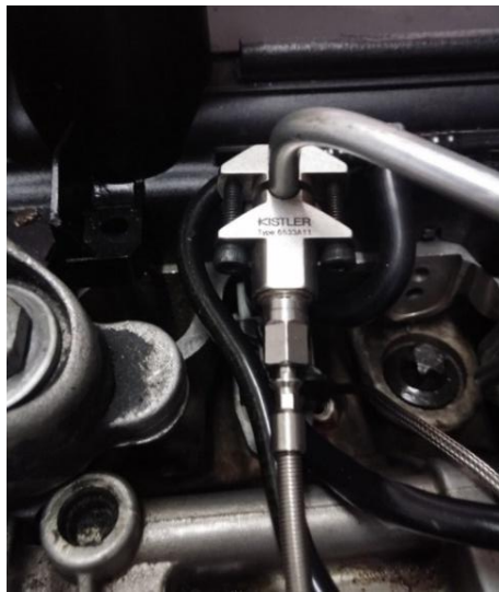
Şekil 2.5. Kistler 6533A11 model yakıt hattı basınç sensörü.
