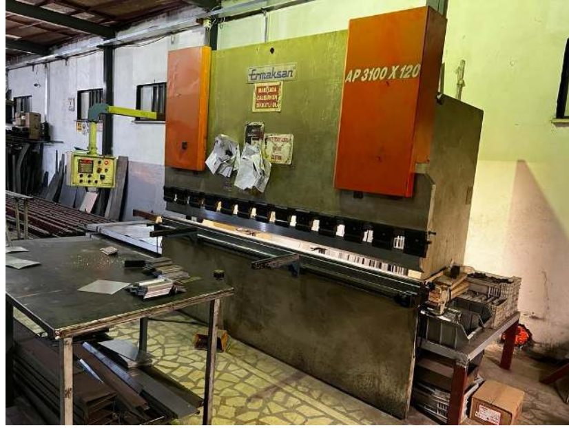
Şekil 4.3. Ermaksan AP 3100 x 120 pres makinesi.
