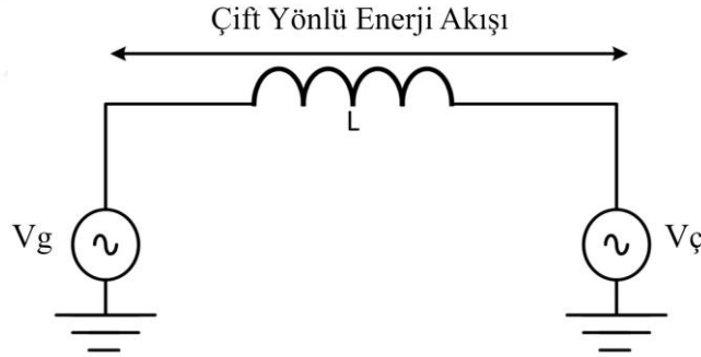
Şekil 35. Çift aktif köprülü dönüştürücünün güç akış benzetimi
