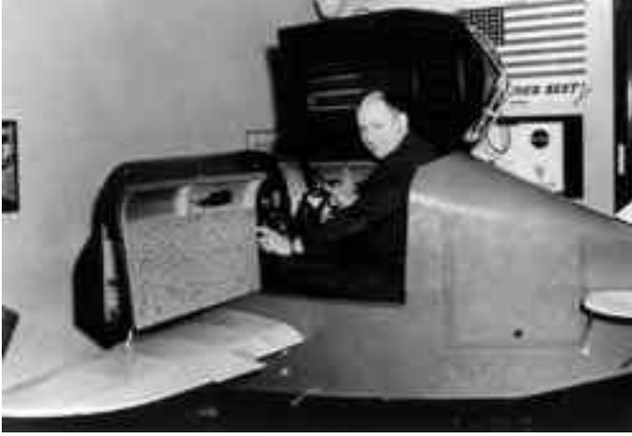
Şekil 2: 1929 yılında Edward Link'in tasarladığı kabin simülatörü "Penguin"
