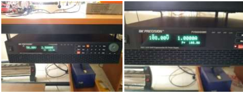
Şekil 3.29. Tez kapsamında temini yapılan güneş dizi simülatörü
