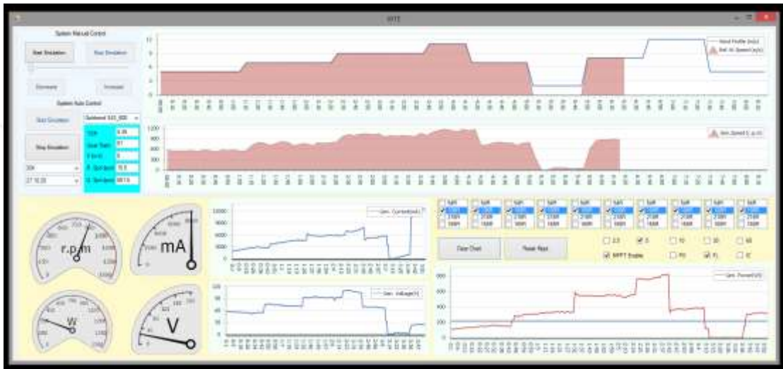
Şekil 3.26. FLC kontrol tekniğinin işletilmesi sonucunda elde edilen elektriksel ve mekaniksel grafikler
