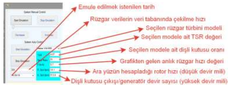
Şekil 3.17. Rüzgâr türbini seçimine imkân sağlayan araç ve bileşenleri
