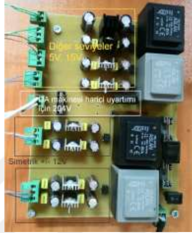
Şekil 3.59. Tasarımı yapılan güç kaynağı katı ve bileşenleri
