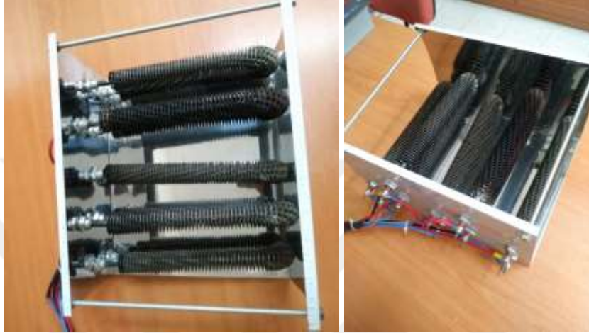
Şekil 3.51. Tasarımı yapılan yük simülatörüne ait yük grubu
