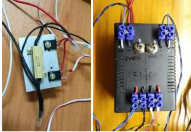
Şekil 3.61. Tez kapsamında tasarlanan manuel yük seçim ünitesi ve doğru akım barasının iç yapısı ve genel görünümü
