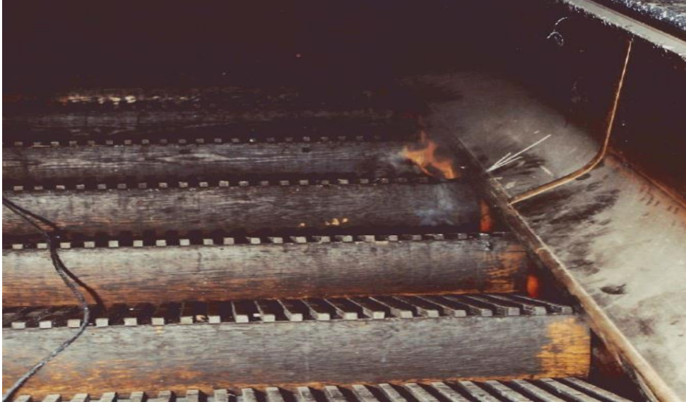
Şekil 4.26: Londra metrosu yürüyen ahşap merdivende yangının başladığı yer
