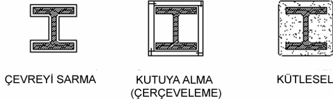
Şekil 3.5: Çelik yapı bileşenlerine uygulanan yalıtım türleri.
