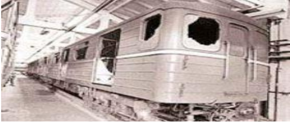
Şekil 4.32: Bakü metrosu yangın sonrası vagonun dış görünümü
