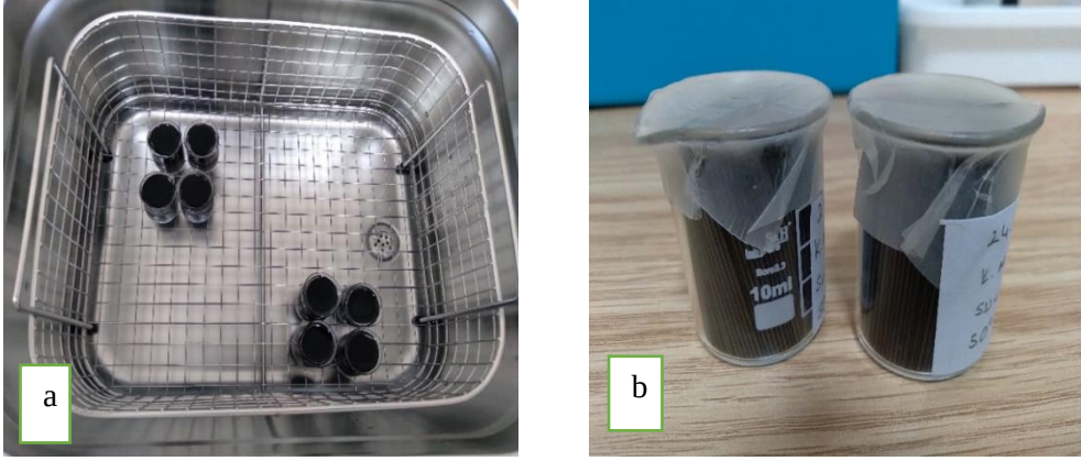
Resim 3.4 Kalem uçlarının ultrasonik banyoda saf su ile yıkanması (a) ve saklanma koşulları (b).
