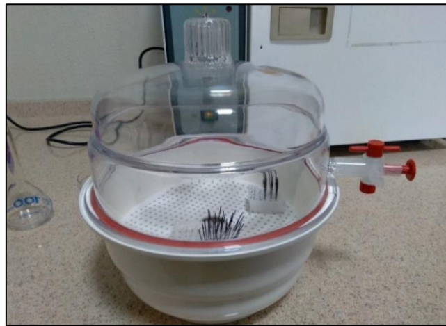
Resim 4.2 KUE/AYPEDOTNF-3dng-2,2V-140s ve KUE/AYPPyNF-5dng-8dng elektrotların vakumlu desikatörde bekletilmesi.
