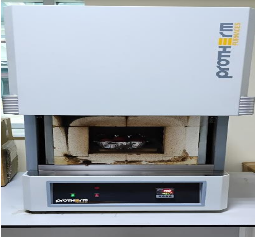
Şekil 31. Erik örneklerinin 450 °C derecede yakılması işlemi
