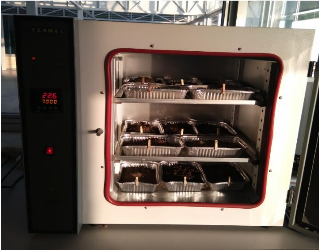
Şekil 28. Toprak örneklerinin etüvde kurutulması
