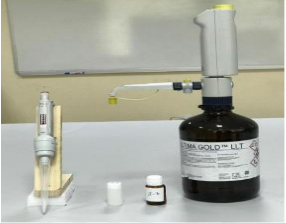
Şekil 42. Ayarlı pipet ile destilatın ölçüm vialine aktarılması
