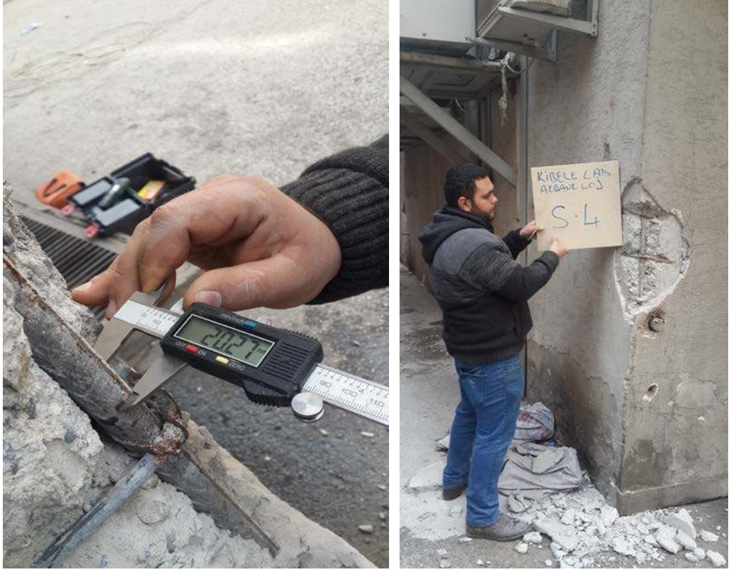
Şekil 3.12. Pas payı sıyrılarak belirlenen donatı detayları
