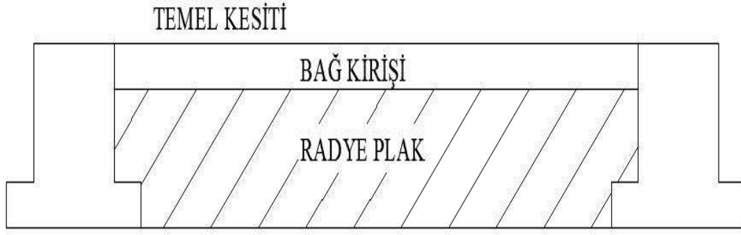
Şekil 4.6. Temel takviye detayı kesiti
