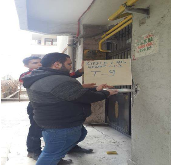
Şekil 3.13. Yüzey sertliği değerin okunması (Schmidt çekiciyle)
