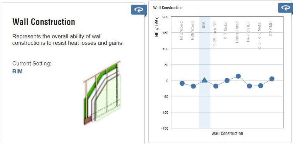
Şekil 5.4. Duvar inşaatı-EUI grafiği (kWh/m 2 /y)
